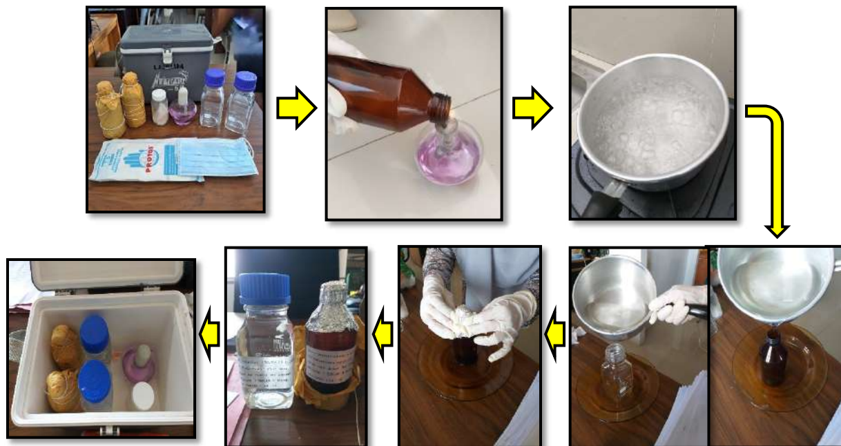
Gambar 2. Tahapan pengambilan sampel air setelah pengolahan
