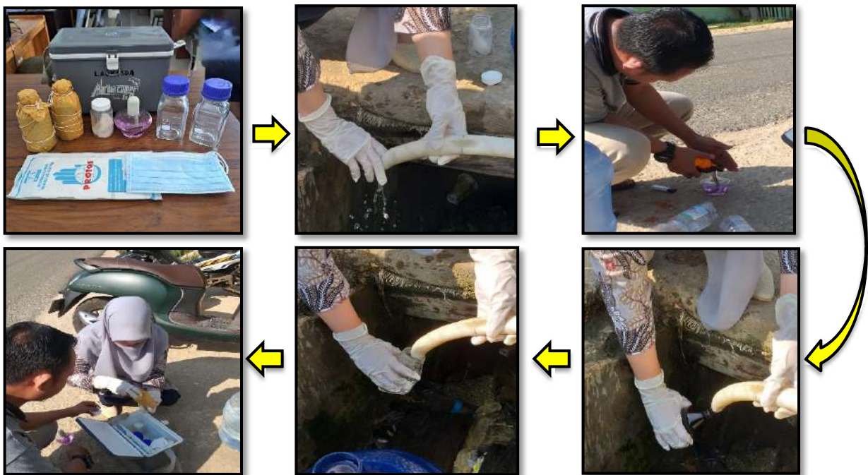
Gambar 1. Tahapan kegiatan pengambilan sampel air sebelum pengolahan
